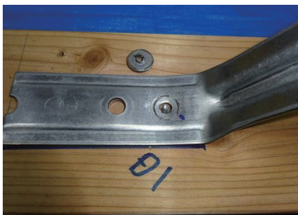
木造での折板接合部確認試験
