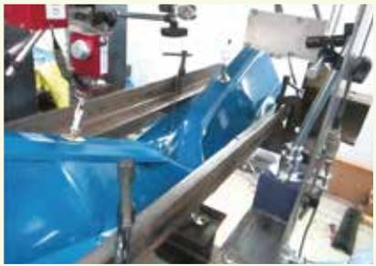
重ね形折板の接合部耐力試験
