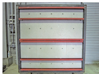
写真2 耐風圧性試験の試験体全景
