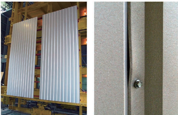
写真3 変形追随性試験の試験体外観と変形状態(1/60時)
