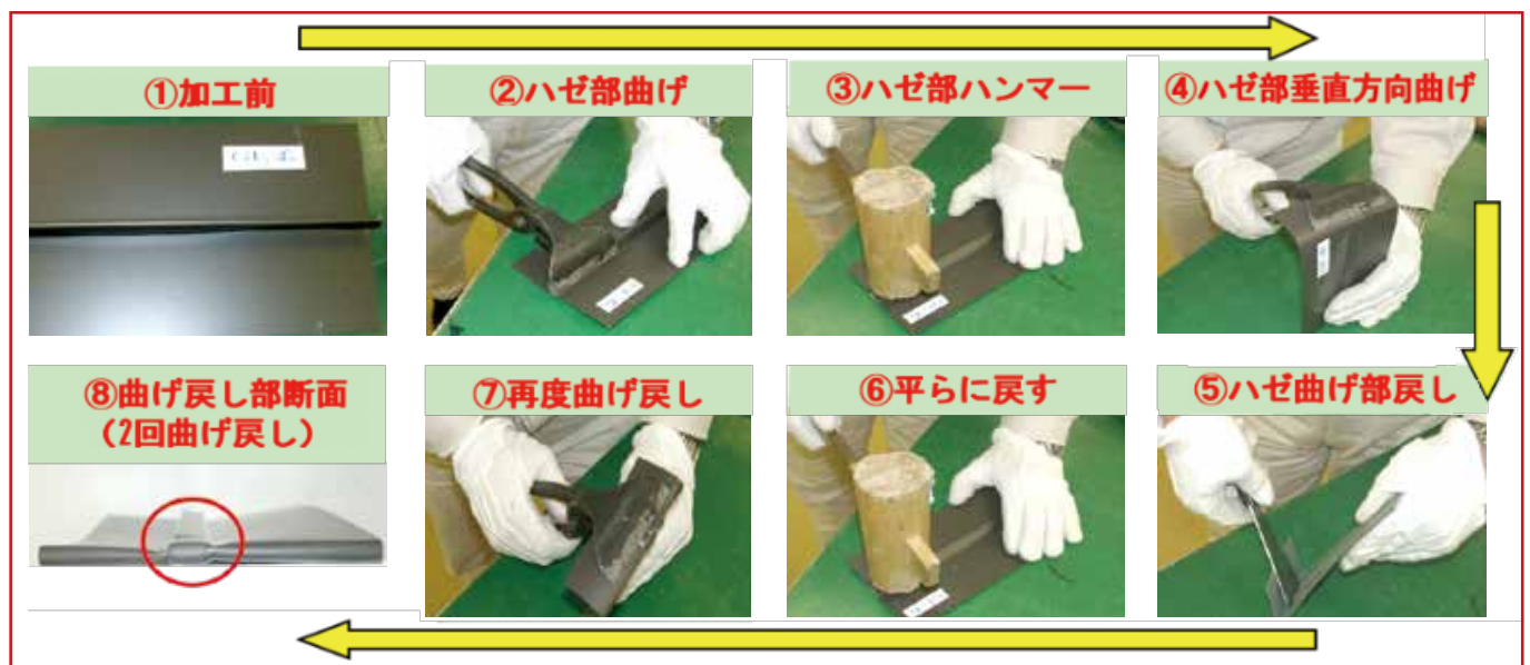
図 16 屋根施工時に現場で行われる加工を模擬した曲げ加工性のテスト方法
