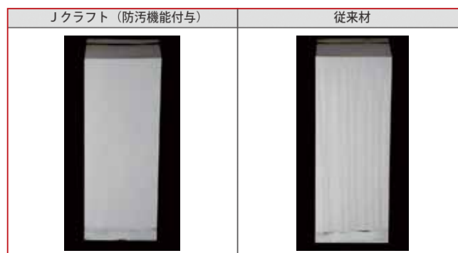
図 6 開発材および従来材の雨筋汚れ性（工場地域暴露 3 ヶ月）
