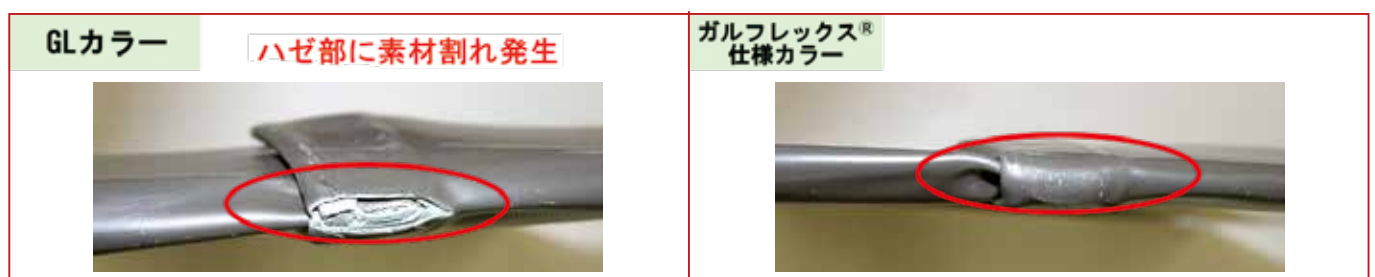
図 17 ハゼ部曲げ加工後の外観
