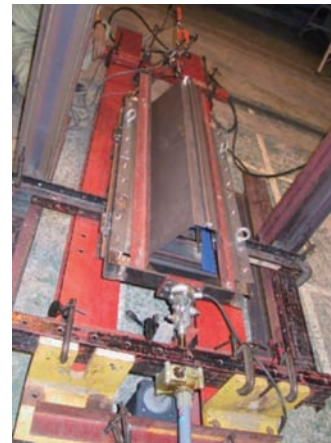
(a) 水平方向の繰り返し載荷試験
