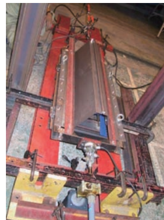
(a) 水平方向の繰り返し載荷試験
