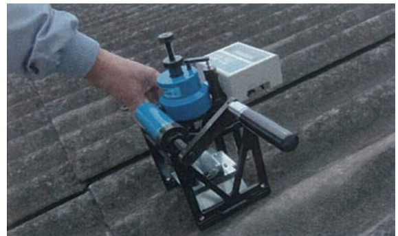
図14 既存フックボルトの耐力調査の例
