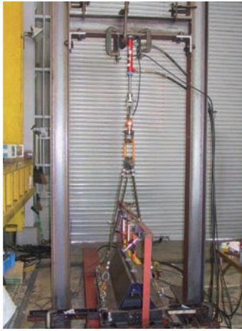
(b)鉛直方向の引上げ試験 図12 試験体の設置概要
