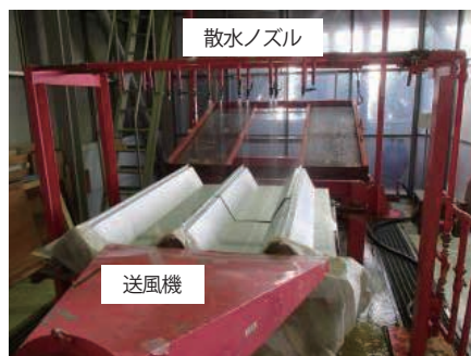
写真-3 散水送風試験機による防水性評価
