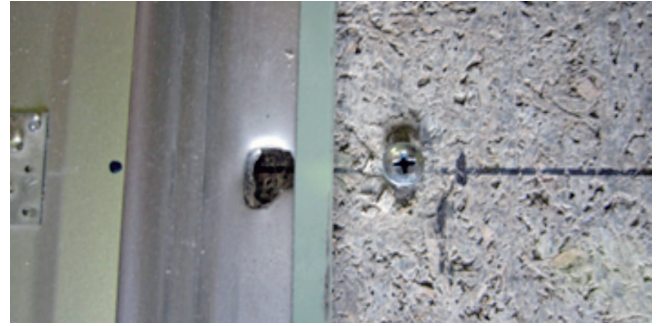
b. 試験体 B-2 (鋼板のねじ頭抜け)
