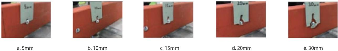
写真 2 せん断方向の各端あき距離における終局状況 (ヘミングなし)
