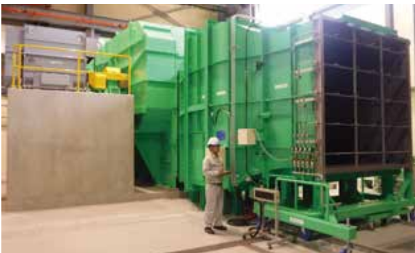
写真1 「送風散水試験」装置 送風機側
