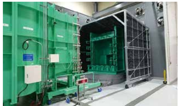
写真2 「送風散水試験」装置 試験体設置側
