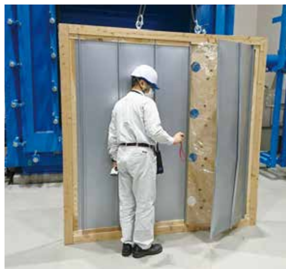
写真8 試験体③の終局状況
