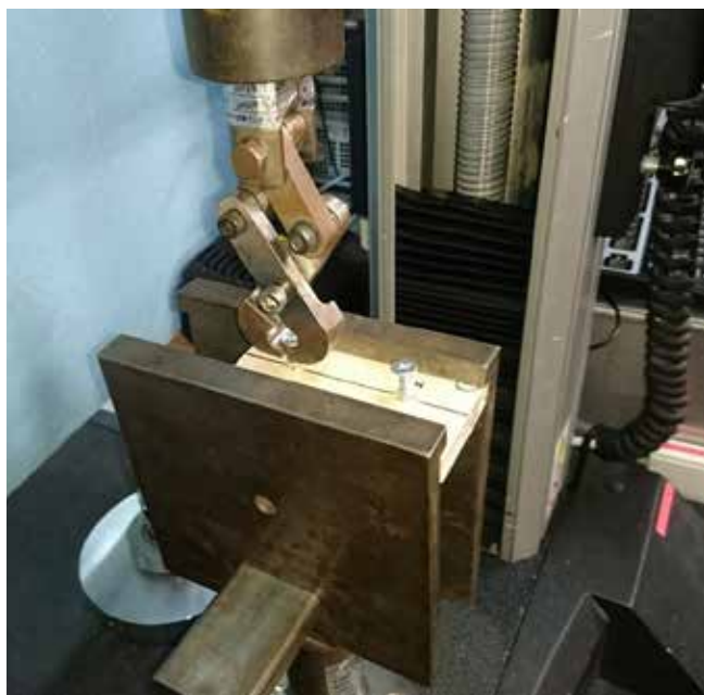
写真2 留め付けねじ単体の「引き抜き」強度試験状況
