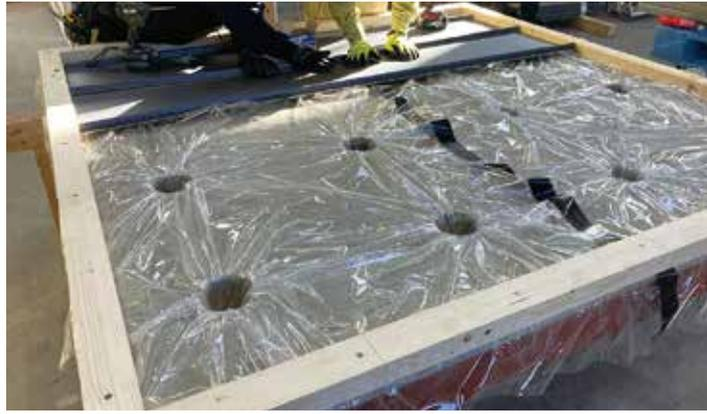
写真1 試験体の製作、野地板の開孔とビニールシート
