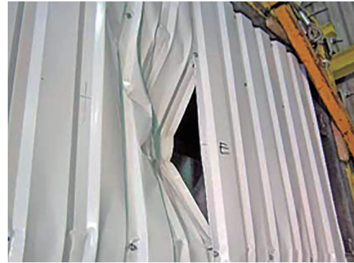
b. ミサイル E の衝撃による開口（重ね部、屋外側）
