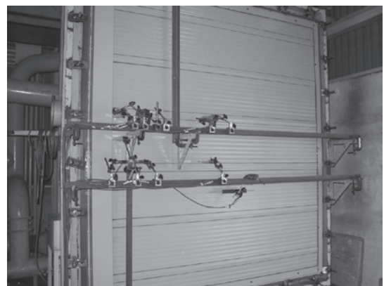
写真3 屋根ふき材アセンブリの耐風圧試験
