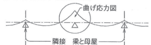
⑥：曲げ応力図 (合成応力図)
