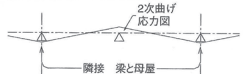
⑤：曲げ応力図 (2次応力負荷図)
