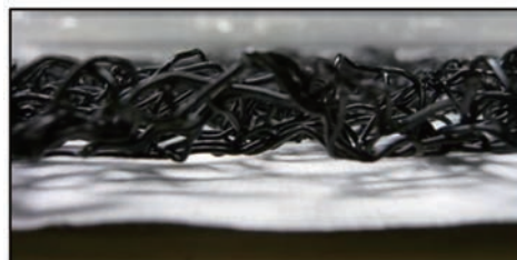
図16 エアギャップシート断面図 上部：立体網状体(厚さ10mm) 下部：タイベックルーフライナー
