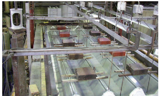
写真-4 折板屋根耐火構造試験
