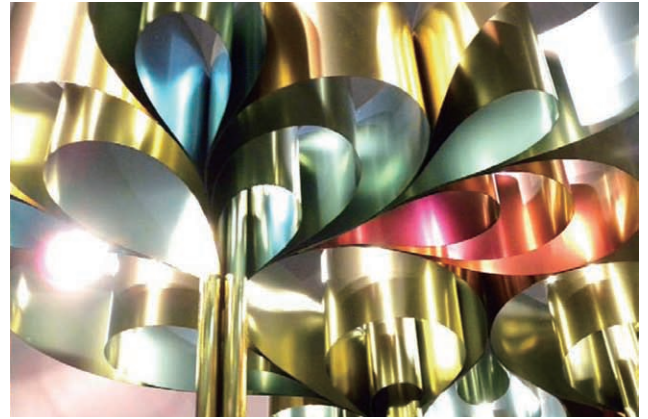
イオンプレーティング法と陽極酸化法を表裏に併用したチタンの発色例
