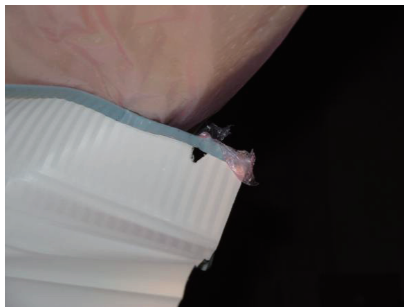
(10) 試験体No.4、釘頭抜け
