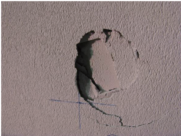
(15) 試験体No.6、ミサイルBの衝突痕
