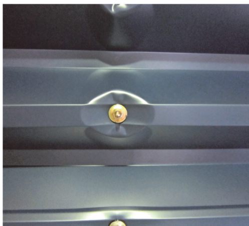
写真1.1 各試験体における耐風圧性能試験後の状況
