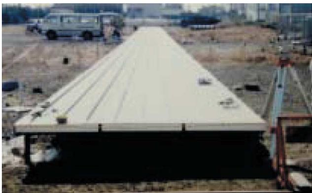
変位の測定は、標点を定め、トランシットで面材の変位を読み取る方法となっています。
