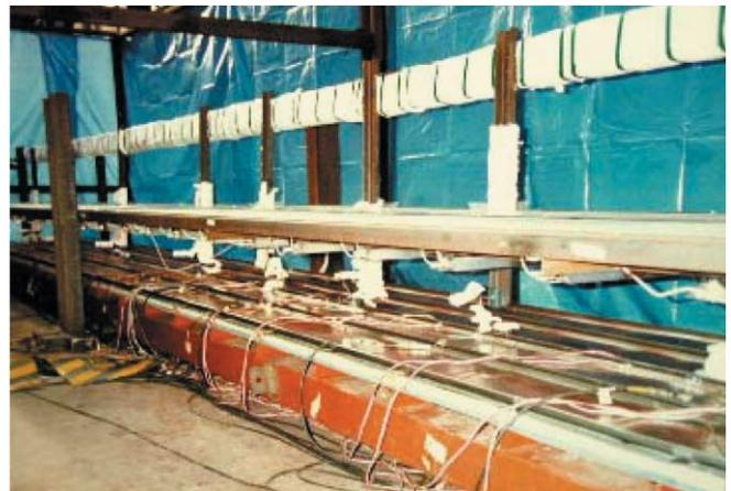
この実験は、屋内で実施したもので、上記の通り、人工条件であり、変位測定についてもダイヤルゲージを用いているなど精度の高い実験となっています。
