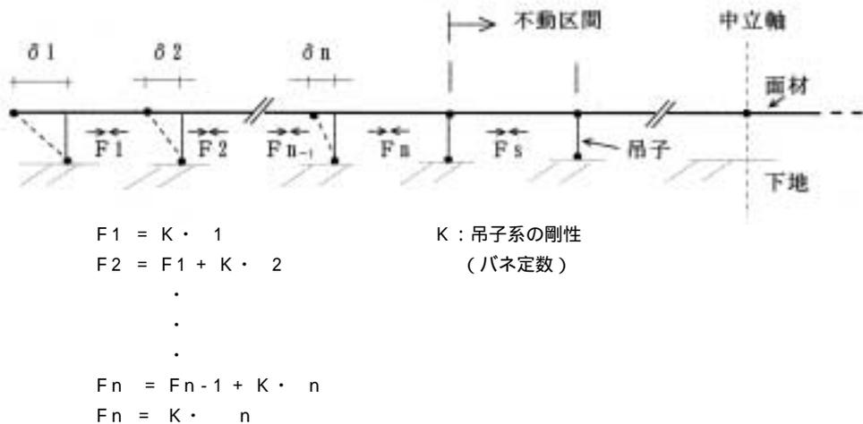
面材の強度（剛性）、吊子の拘束力・下地の状況によって は変わり、不動区間も変化する。
