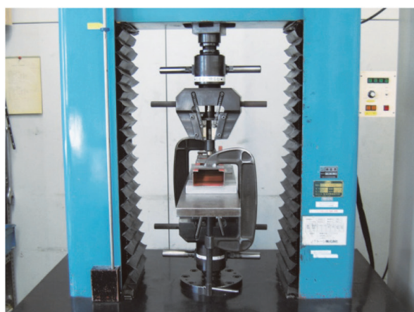
写真1 鋼製下地への留付け方法確認試験状況
