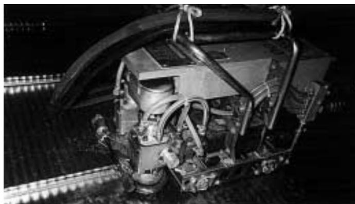
一般面用シーム溶接機の溶接風景
