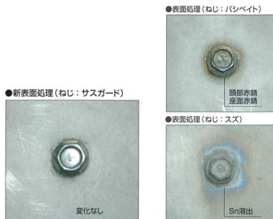
写真2. 接触腐食の比較
